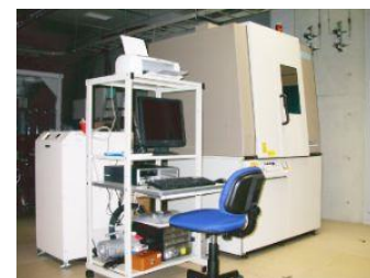
X線回折装置(XRD) ・結晶性評価
