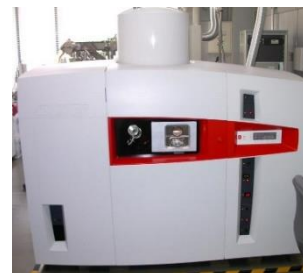
X線光電子分光分析装置(XPS) ・組成分析 ・原子結合力評価
