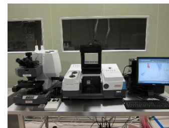
フーリエ変換赤外分光装置(FT-IR) ・基板表面の分子終端評価
