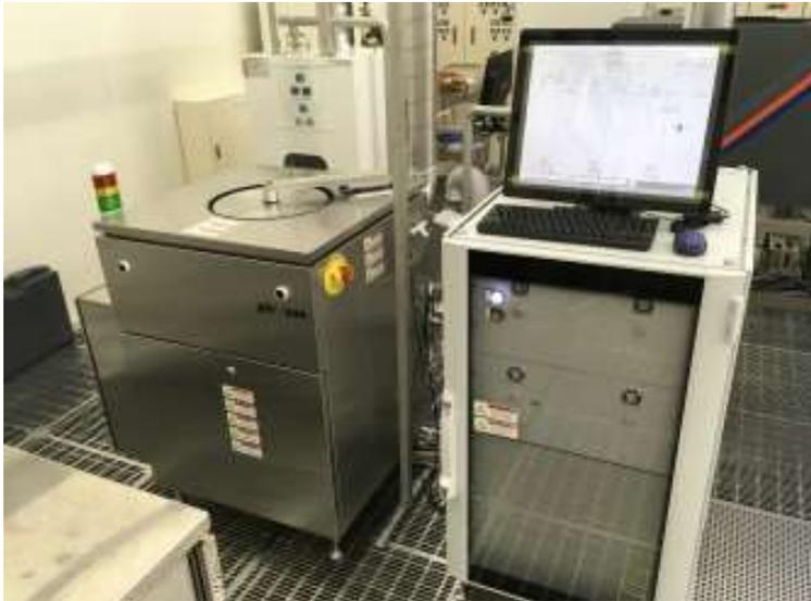
成膜材料:  $\text{Al}_2\text{O}_3$ 、 $\text{TiO}_2$  (酸化剤  $\text{H}_2\text{O}$ )
