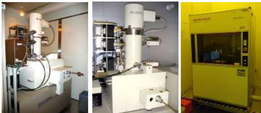
超高精度電子線描画やレーザー描画装置による微細加工
