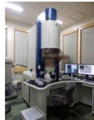
収差補正透過電子顕微鏡
