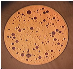
PDA無 (電極陥没発生)
