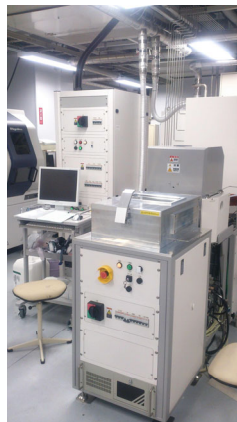
プラズマCVDによる成膜支援 PD-100ST/Multiplex-CVD
