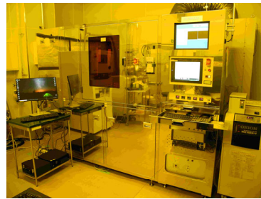
マスクレス露光装置 0.8umL&Sが可能 MX1205 (MIX&MATCHでも運用)
