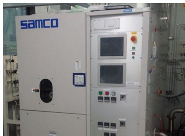
プラズマCVDによる成膜支援 PD-100ST/Multiplex-CVD
