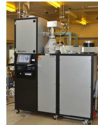
ALDによる絶縁膜支援 Ultratech製 Fiji F200 ロードロック付き
