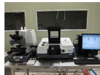
フーリエ変換赤外分光装置 (FT-IR) ・基板表面の分子終端評価
