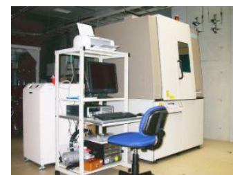
X線回折装置 (XRD) ・結晶性評価
