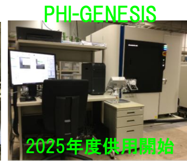
X線光電子分光分析装置 (XPS) ・組成分析 ・結合状態評価
