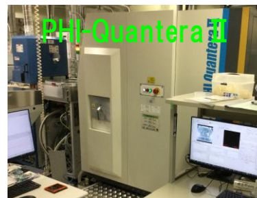
X線光電子分光分析装置 (XPS) ・組成分析 ・結合状態評価
